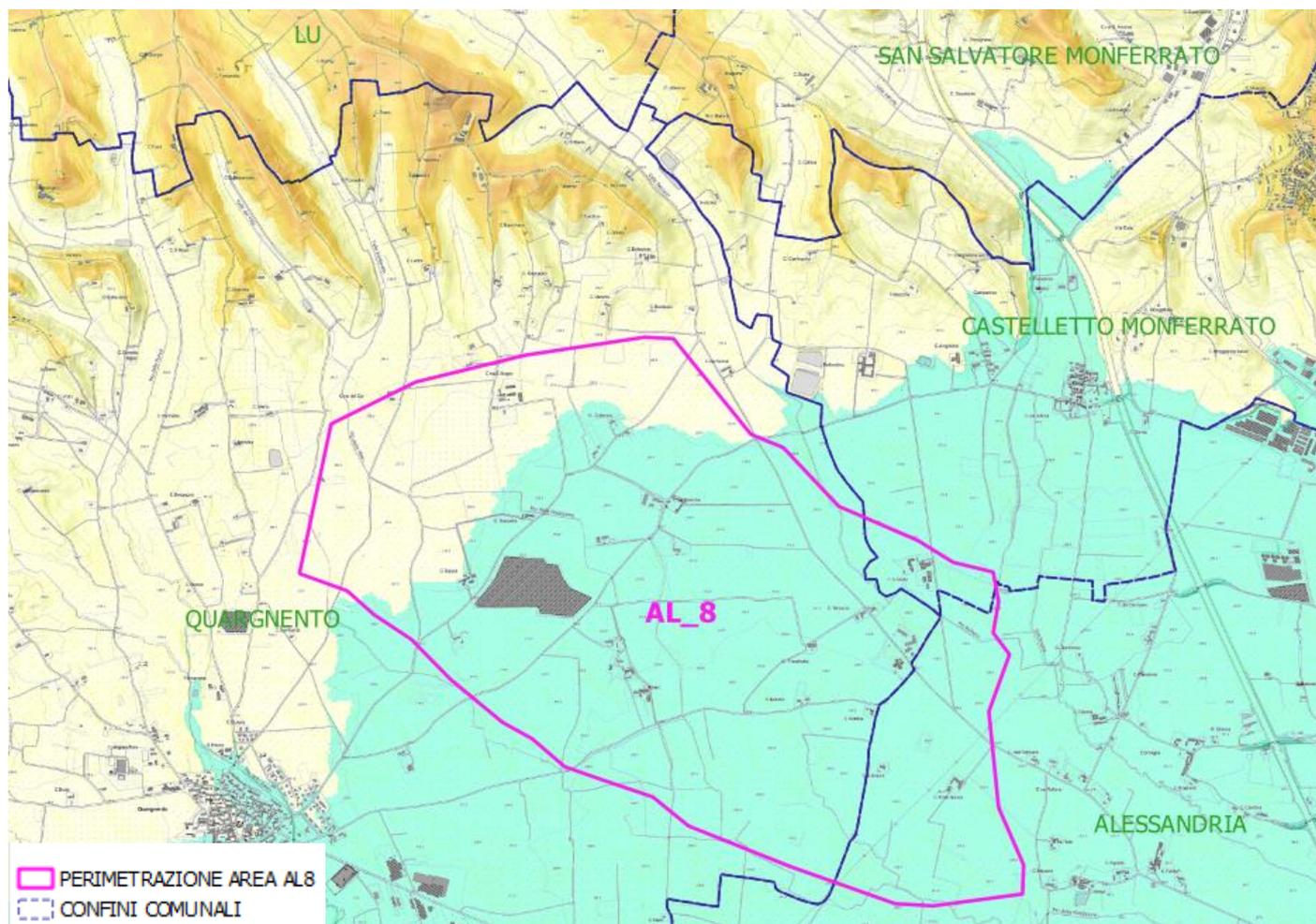
Ricostruzione rilievo planoaltimetrico area AL8: in colore verde l'area pianeggiante, in colore giallo da più chiaro a più scuro le aree da subpianeggianti a mediante acclivi ed in colore marrone chiaro le aree collinari
